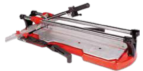
RUBI CORTADOR MANUAL CERÁMICA 1008764 Profesional TX 1020 MAX. Longitud de corte: 102 cm, corte diagonal 70x70 cm, espesor de corte: 3-21 mm, corte angular con tope para 15°, 30°, 45°, potencia separador de 1.200 Kg. 595'00 + IVA = 719'95
